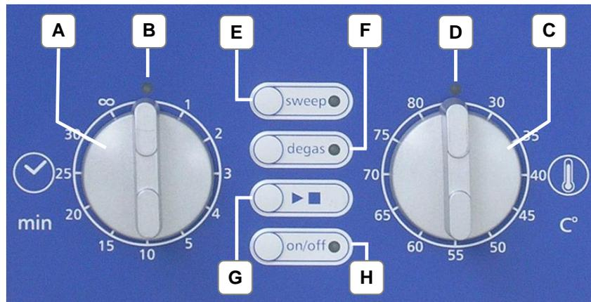
Bild 4.8 Ansicht Bedienelemente Elmasonic S 10 H
